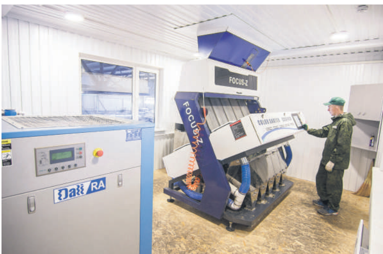
Работают две линии очистки семян с использованием оптических сортировщиков, которые позволяют получать чистоту семян 99,9%.
